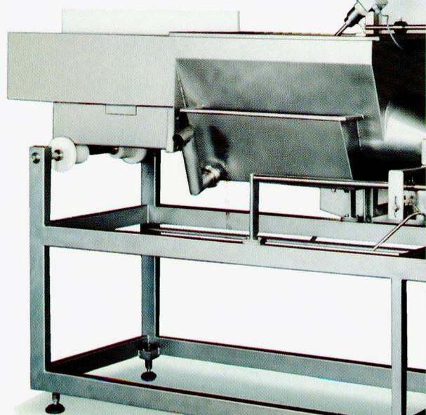
Eine Brückensteuerung tastet den Kolben ab und gewährleistet dadurch eine sehr hohe Abfüllsicherheit. Unterfüllungen sind nahezu ausgeschlossen, da die Maschine sofort stoppt, wenn die gegebene Füllmenge nicht erreicht wird.
